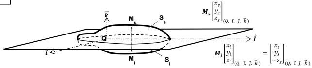
Le plan (Q,  $\vec{x}$  ,  $\vec{y}$  ) est plan de symétrie matérielle du solide S. On peut écrire :  $S = S_s \cup S_i$  , avec  $S_s = S_i$
