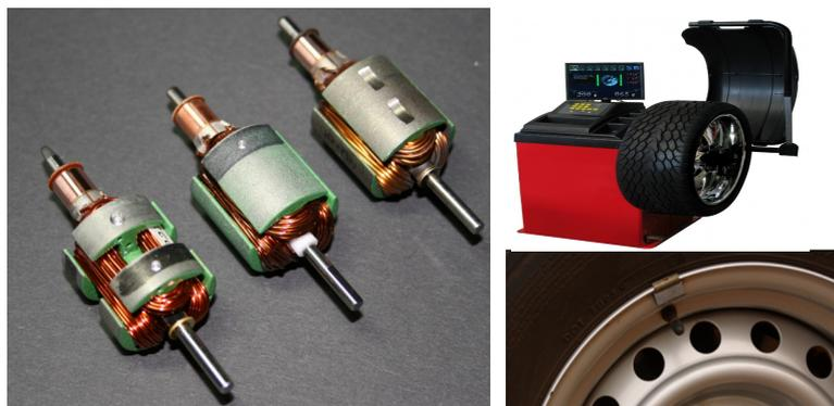
**Figure.4. Equilibrage dynamique par ajout et enlèvement de matière :**
