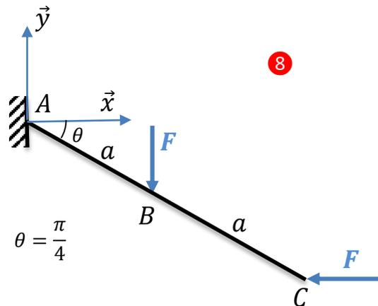
**Question 1: Isoler le solide et déterminer les torseurs des actions extérieures sur celui-ci.**
