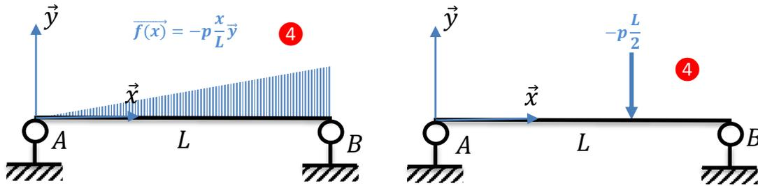
**Question 1: Isoler le solide et déterminer les torseurs des actions extérieures sur celui-ci.**
