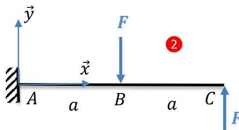
**Question 1: Isoler le solide et déterminer les torseurs des actions extérieures sur celui-ci.**
