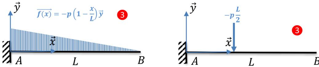
Question 1: Isoler le solide et déterminer les torseurs des actions extérieures sur celui-ci.
