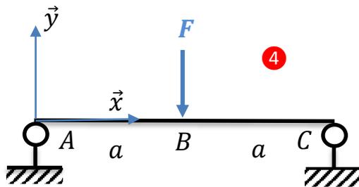
**Question 1: Isoler le solide et déterminer les torseurs des actions extérieures sur celui-ci.**
