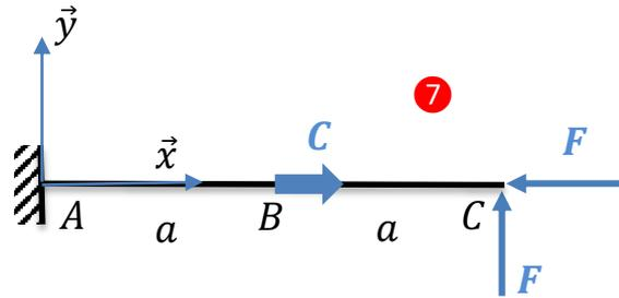
**Question 1: Isoler le solide et déterminer les torseurs des actions extérieures sur celui-ci.**
