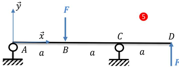
Question 1: Isoler le solide et déterminer les torseurs des actions extérieures sur celui-ci.
