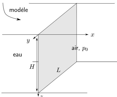
On considère le barrage de Serre-Ponçon (dans les Hautes-Alpes), qui forme la plus grande retenue d'eau d'Europe. On le modélise par un rectangle vertical de hauteur 115 m et de largeur 630 m (comme sur le schéma ci-dessous).
