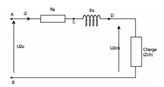
4 – On fait débiter le secondaire sur un récepteur d'impédance 0,5  $\Omega$  de facteur de puissance 0,8 inductif. Donner l'expression complexe Zch de l'impédance de ce récepteur ainsi que l'impédance générale ZAB du dipôle AB apparaissant dans le circuit équivalent de Kapp ramené au secondaire. En déduire l'intensité efficace du courant dans la charge et la tension efficace aux bornes de la charge U2ch.
