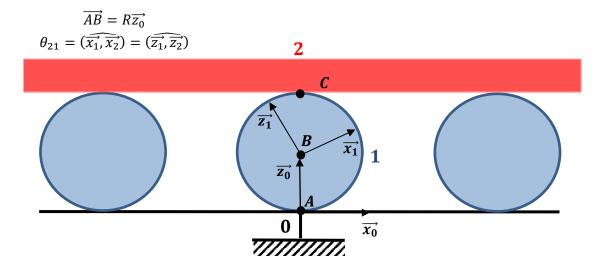
Question 1: En exploitant la propriété de roulement sans glissement en A, exprimer la vitesse  $\vec{V}(B,1/0)$  en fonction de R,  $\Omega_{10}$  et d'un vecteur donné
