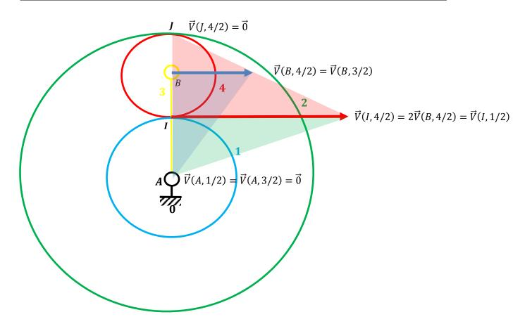
Question 19: En exploitant le fait que la vitesse en B soit une vitesse identique dans deux mouvements différents, montrer que  $-R_3\omega_{3/2}=R_4\omega_{4/2}$
