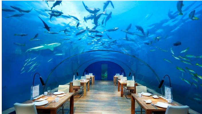
Dans le but de dimensionner la structure supportant la baie vitrée, nous souhaitons déterminer le torseur de l'action de l'eau sur celles-ci. On suppose que les baies vitrées ont une structure cylindrique de rayon constant  $R$  et on propose le modèle suivant, pour une tranche d'épaisseur  $dy$  :
