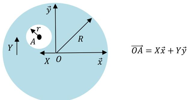
On suppose que la pression se répartie uniformément sur la surface de contact :  $\overrightarrow{p(x, y)} = -p\vec{z}$
