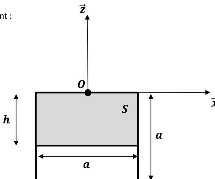
Le fluide sous pression est supposé être du côté des  $y$  négatifs (côté du lecteur). L'autre côté est soumis à la pression atmosphérique de l'air notée  $P_0$ .
