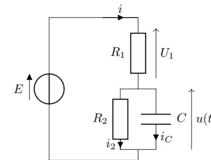
1. À  $t = 0^-$  le condensateur est déchargé et la tension à ses bornes vaut 0 V. Comme la tension aux bornes du condensateur est continue, à  $t = 0^+$  elle vaut toujours 0 V.
