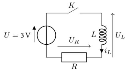
1. Au moment où l'on ferme l'interrupteur, l'intensité du courant qui circule dans la bobine est nulle. Comme l'intensité du courant qui circule dans la bobine est constante, on sait qu'à  $t = 0^+$  elle sera encore nulle.
