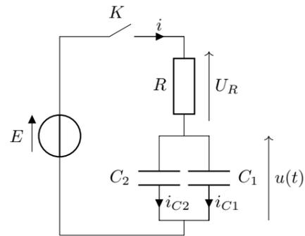
1. La loi des mailles donne  $E = U_R + u = Ri + u$ . Et la loi des nœuds donne  $i = i_{C1} + i_{C2} = C_1 \frac{du}{dt} + C_2 \frac{du}{dt} = (C_1 + C_2) \frac{du}{dt}$ . Donc finalement :
