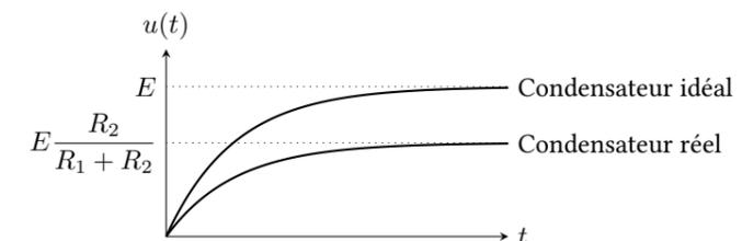
2. Pour un condensateur idéal  $R_2 = \infty$  et la tension à ses bornes en régime permanent vaut  $u(\infty) = E$ .
